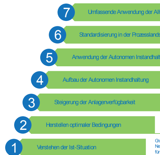
Abb. 3: Die sieben Schritte der Autonomen Instandhaltung.
